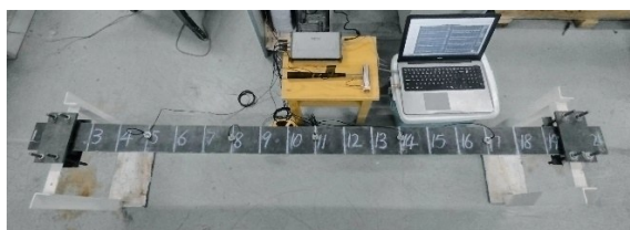
图9 外伸梁试验
