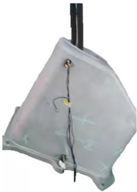
图 3 缸盖罩模态测试悬挂方式
