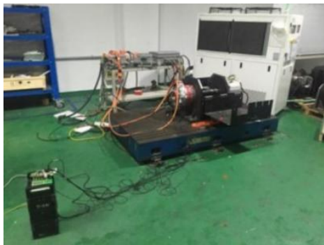
图2 样机振动扫频阶次试验现场
