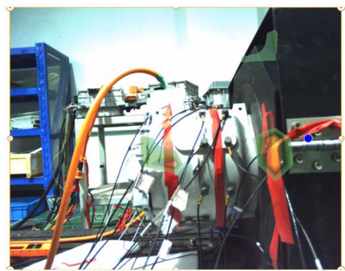
图 8 样机空载 2 500 r/min 声全息试验-侧面
