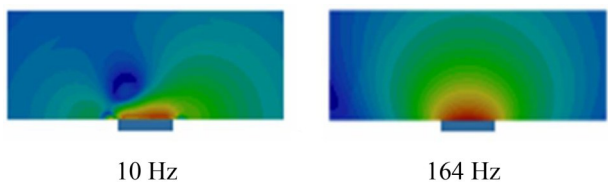
图12 工况1带格栅腔体结构场点1处声辐射分布
