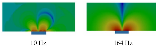
图14 工况2带格栅腔体结构场点1处声辐射分布
