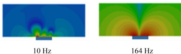
图13 工况1带格栅腔体结构场点2处声辐射分布
