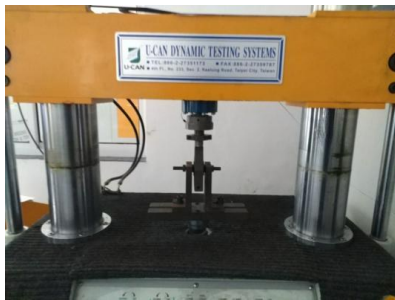
图8 橡胶衬套径向试验安装方案
