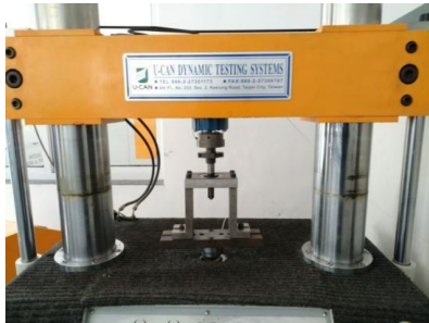
图9 橡胶衬套轴向试验安装方案
