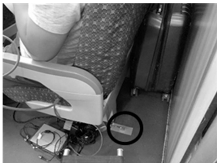
图 1 车体振动测点布置
