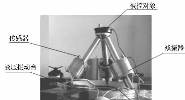
图1 微振动平台结构图
