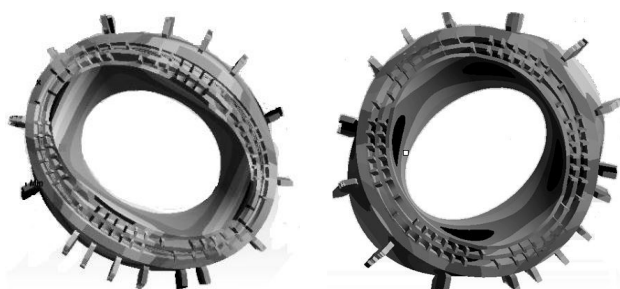
(a) 第1阶椭圆 (对应频率 79.16 Hz) (b) 第2阶模态 (对应频率 112.53 Hz)
