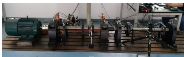
(a) HZXT-DS-001 双跨度转子综合实验台
