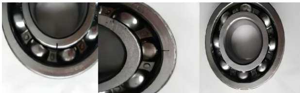
(b) 内圈外圈及滚动体故障
