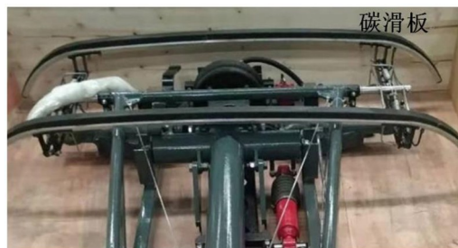
图 2 地铁受电弓及碳滑板结构
