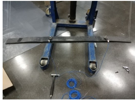
图4 碳滑板锤击实验
