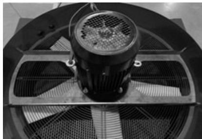
图4 电机支撑系统
