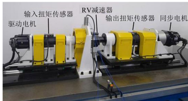
图2 机器人减速器综合性能测试系统
