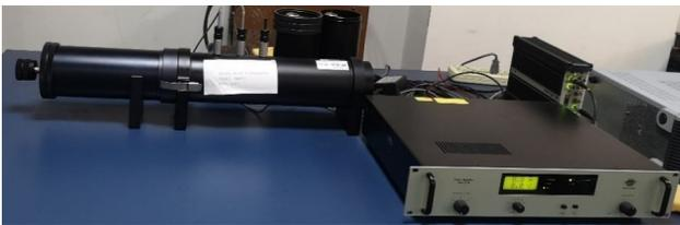
图3 声学阻抗管测试系统
