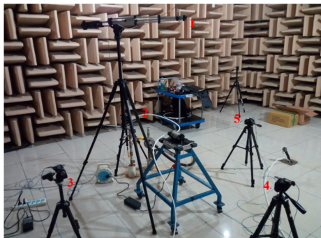
图3 声压级测量实际测点布置图
