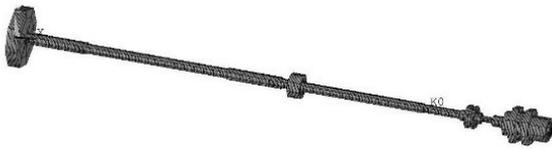
图 12 轴系试验台有限元模型
