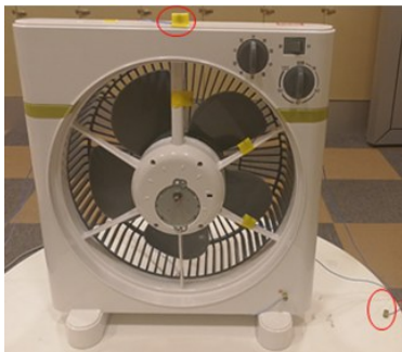
图1 转页扇原始结构振动测试传感器布置
