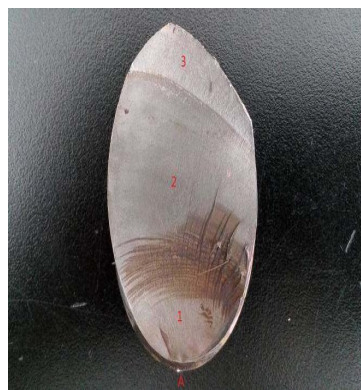
图2 螺栓断面宏观示意图
