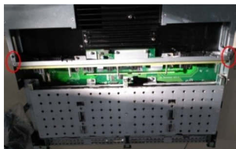
(b) 在中间骨架两侧增加螺钉
