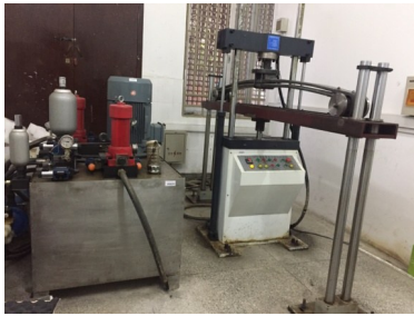
图3 钢板弹簧台架试验
