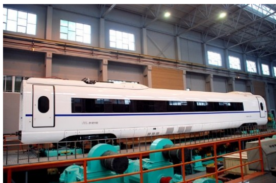
图4 滚动振动试验台测试车辆
