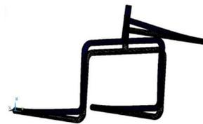
图3 管道4阶模态振型图
