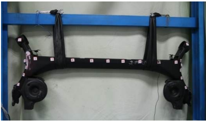
图 8 破损件悬挂方式和布点
