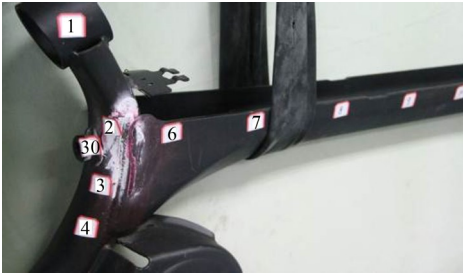
图 9 扭力梁式后悬架破损位置
