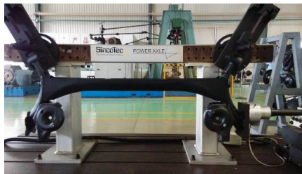
图 6 弯曲疲劳试验机
