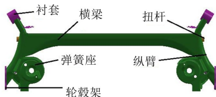
图1 扭力梁式后悬架三维CAD图
