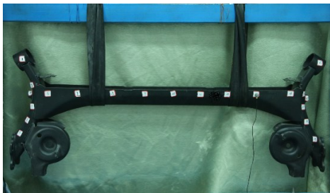
图2 扭力梁式后悬架悬挂方式
