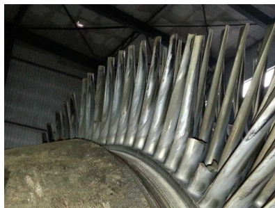
图12 汽轮机叶片断裂
