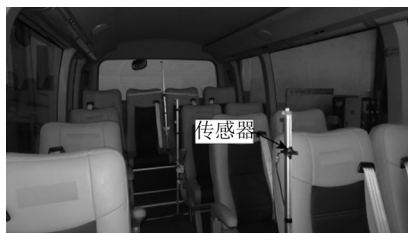
图5 车内噪声测点
