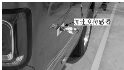
图4 车外振动测点
