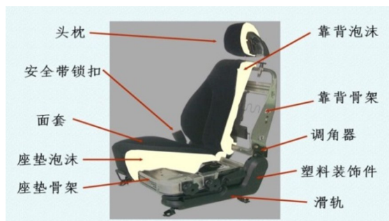
图1 座椅结构组成
