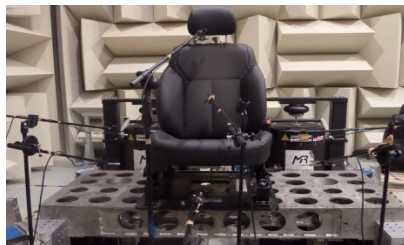
图8 异响试验声信号采集设置
