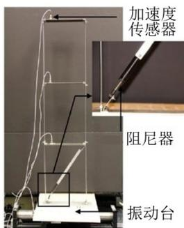
图4 三层框架结构试验图
