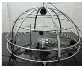
图11 实验麦克风布置
