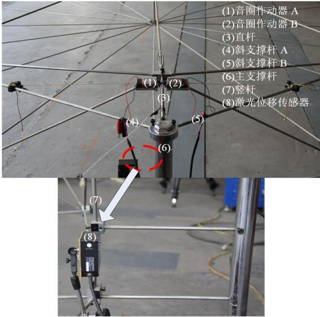
(1) 音圈作动器 A (2) 音圈作动器 B (3) 直杆 (4) 斜支撑杆 A (5) 斜支撑杆 B (6) 主支撑杆 (7) 竖杆 (8) 激光位移传感器
