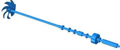
图2 螺旋桨-轴系耦合系统有限元模型
