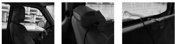
图5 声压传感器布置位置
