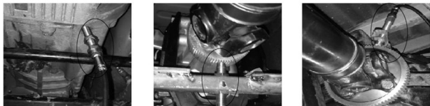
图4 磁电扭振传感器布置位置
