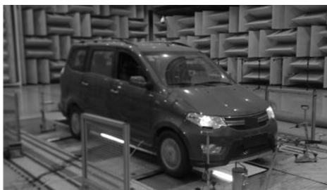
图3 半消声室整车转鼓试验
