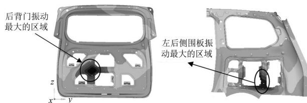
(a) 后背门内板振型云图 (b) 左后侧围内板振型云图
