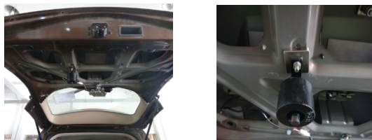
图7 动力吸振器布置图
