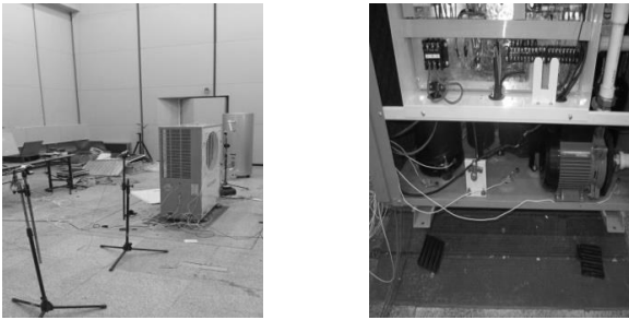
图2 传声器及部分加速度传感器布置情况
