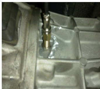
变速器输入轴处传感器
