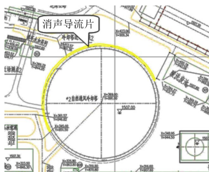
图6 2#自然通风冷却塔降噪措施示意图
