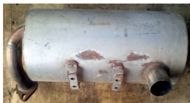
图8 优化后消声器实物
