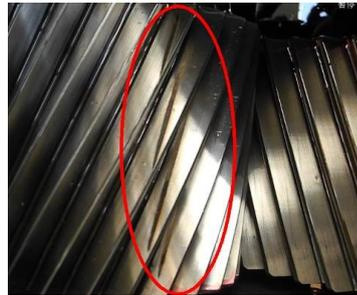
图7 高速齿轮划痕损伤
