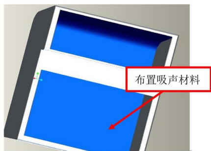
图6 出风筒内部吸声布置
