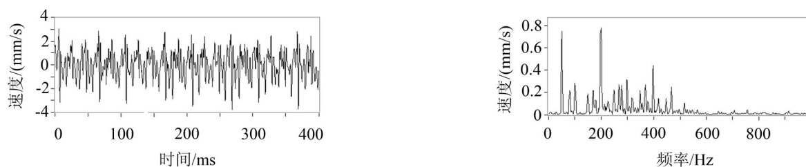
图8 检修后电机自由端径向振动时域与频域图(速度)
