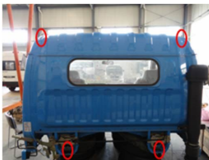
图2 驾驶室测点及支撑方式
