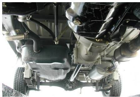
图2 微型客车动力及排气系统布置形式
