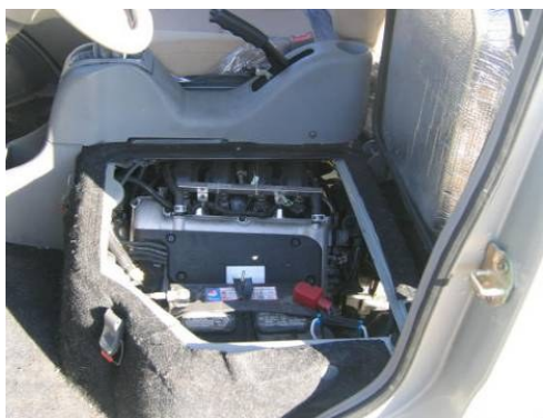
图1 微型客车发动机舱布置形式
