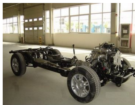
图3 轻型客车发动机及底盘布置形式
